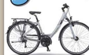
Gabel: Suntour NEX HLO lockout, Federung: Stahlfeder/Oil Schaltung: Shimano Deore, 30-Gang Kettenschaltung
