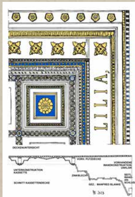
↑ Detailzeichnung Kassette Ansicht und Schnitt
